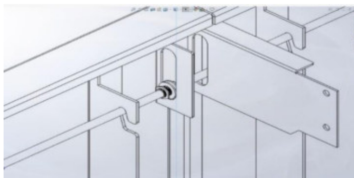
Figura 21 Fissatore parete – posizionamento
