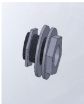
Figura 20 Fissatore parete (inserire 2 rondelle in mezzo)
